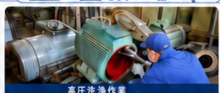
高圧洗浄作業
